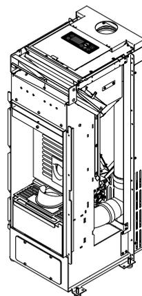
Le poêle à granulés ALIAS 2N est doté de la technologie ventilation désactivable pour un fonctionnement silencieux. Il possède également plusieurs vitesses de soufflerie pour s'adapter aux différents volumes d'habitation. Sa sortie centrée sur le dessus est un atout esthétique indéniable pour ce poêle simple et performant.
