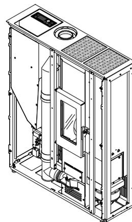
ACE, est un poêle à granulés étanche. Il se caractérise pour une profondeur réduite et un conduit de fumées intégré pour limiter au maximum l'empiétement de l'appareil dans l'habitation et d'un deuxième ventilateur canalisable et indépendant pour le chauffage d'une pièce adjacente. Sa capacité de réservoir importante permet une autonomie en fonctionnement continu jusqu'à 30 heures.
