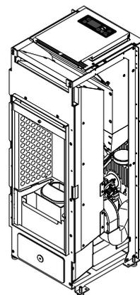
Le poêle à granulés THULE-2N possède une ventilation frontale dotée de plusieurs vitesses de soufflerie et deux sorties arrières canalissables pour vous permettre de chauffer 3 zones séparées de votre habitation.
