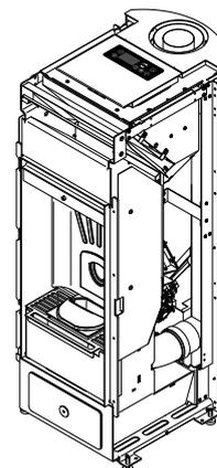
Le BOREA est un poêle à granulés étanche sous avis technique du CSTB. Il dispose de la technologie ventilation désactivable pour un grand confort thermique et acoustique. Sa sortie de fumée concentrique supérieure lui confère une grande adaptabilité et une esthétique remarquable.
